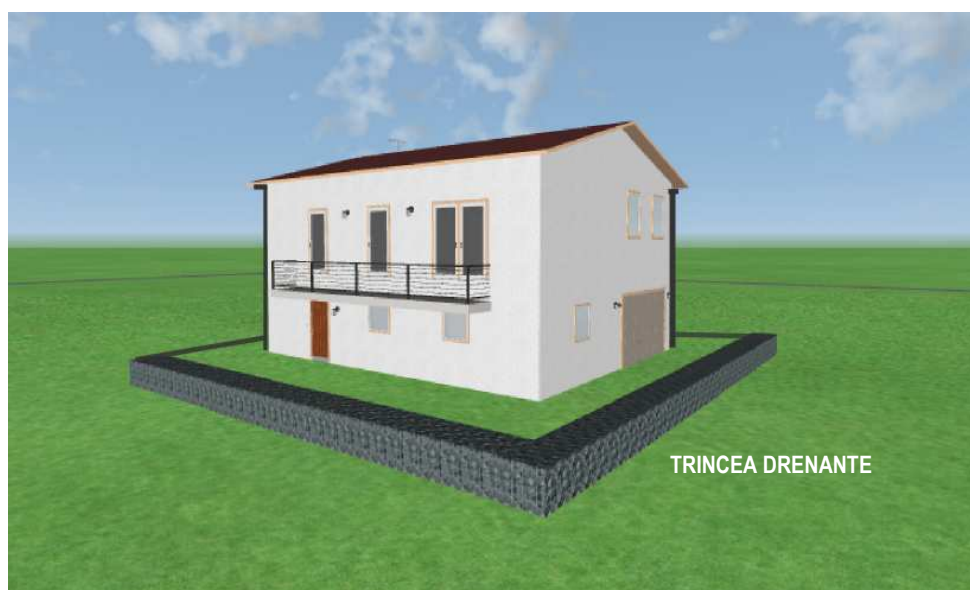
Schema posa trincee drenanti per edificio singolo
