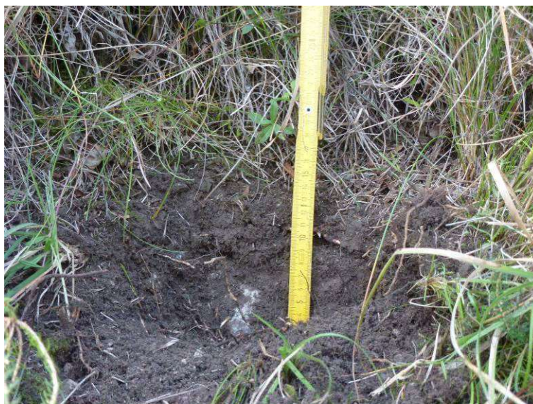
Figura 47 - Misurazione a campione della potenza del terreno sulla Costa di Fregona
