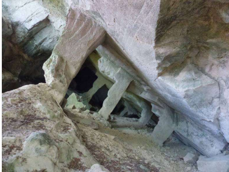
Figura 97 – Pilastrini di sostegno residui dello strato di arenaria estratto
