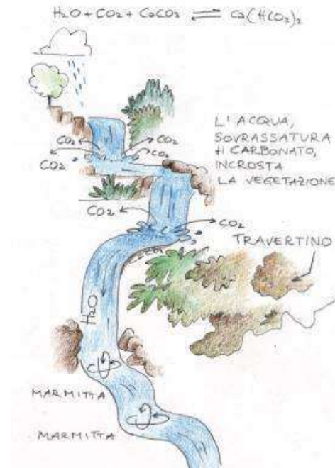
Figura 37 - (*) Schema di formazione del travertino
